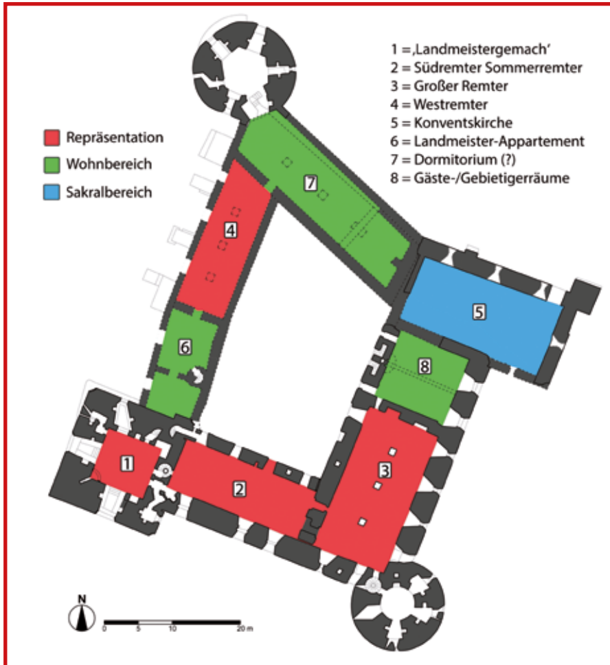
Abb. 6 Burg in Wenden, Grundriss des Hauptgeschosses in Wenden mit Rekonstruktion der Raumfunktionen
